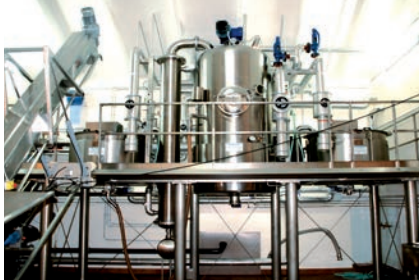
Impianto per la produzione sottovuoto delle confetture extra, nello stabilimento Luxardo.
